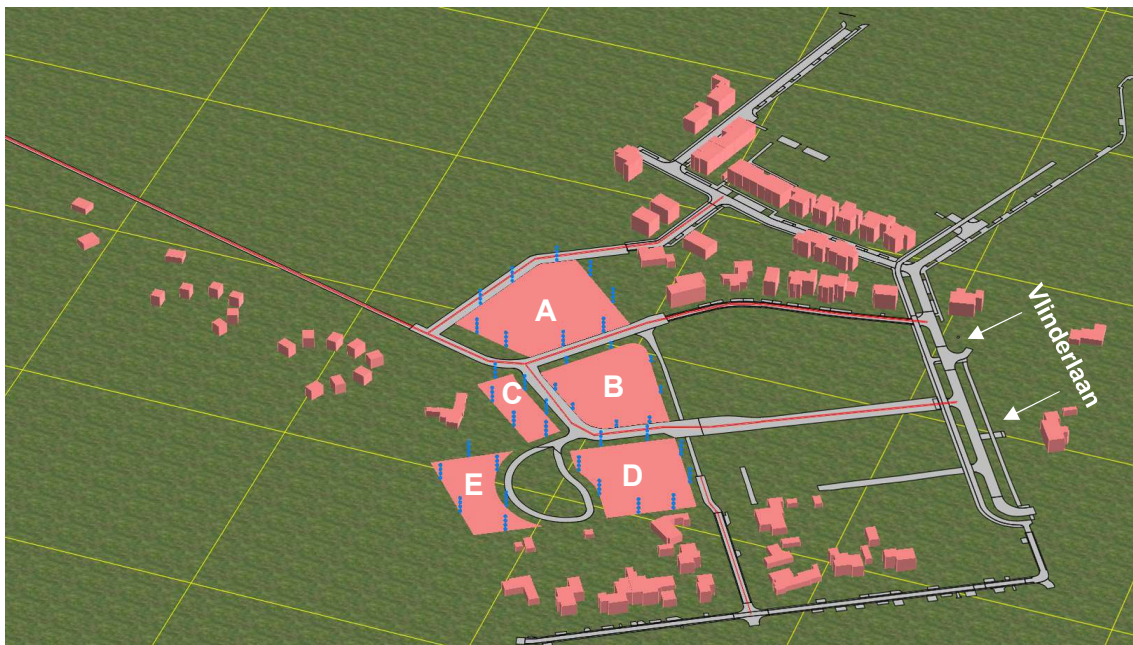
Figuur 4.2: Weergave 3D-omgevingsmodel wegverkeerslawaaiberekening met aanduiding bouwvlakken en Vlinderlaan.
