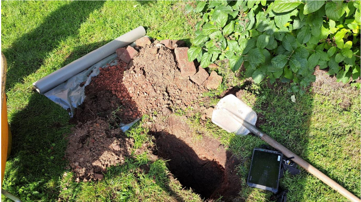
Aangetroffen septic put bij meetpunt 4 uit verkennend bodemonderzoek 2022
