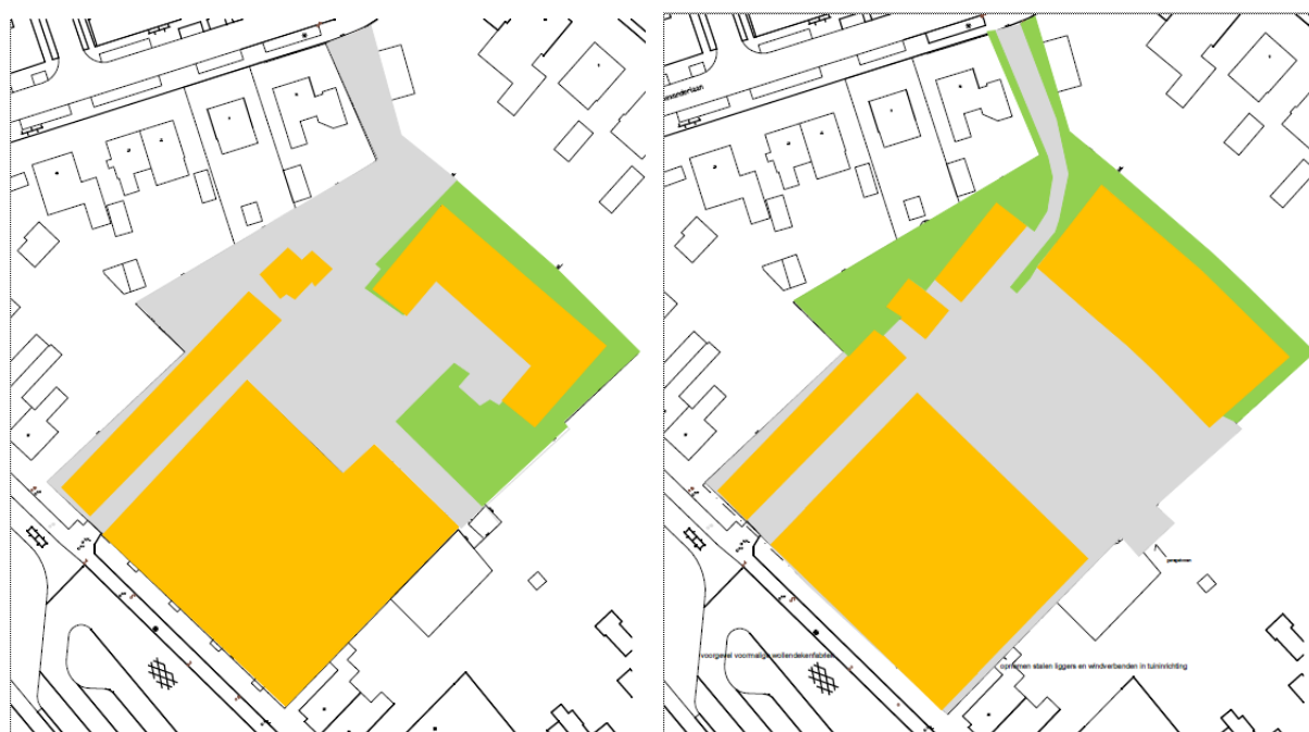
Figuur 1.2 Huidige situatie (links) en toekomstige situatie (rechts) Parallelweg 26 te Geldrop. In oranje is dakoppervlak weergegeven, in grijs de terreinverharding en in groen het onverhard oppervlak.
