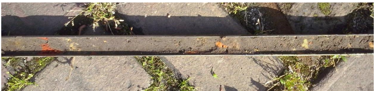
Figuur 21: Foto van boring 4 met daarin het homogene humushoudende zandpakket met daarin een tamelijk egale spreiding van deeltjes baksteenpuin.
