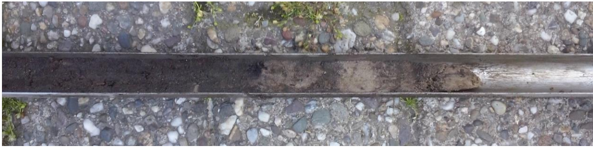
Figuur 22: Foto van boring 5 met daarin de gelaagde beekafzettingen zoals deze ook in boring 7 zijn aangetroffen.
