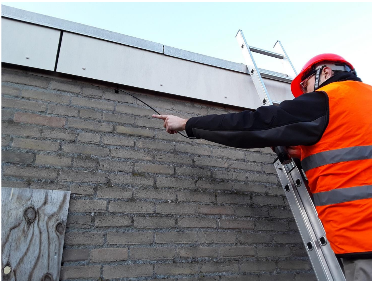
Figuur 3 Endoscooponderzoek van geschikte holtes.
