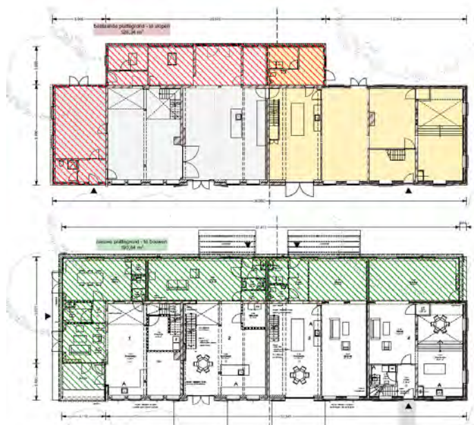
Figuur 10. Geplande sloop/nieuwbouw.
