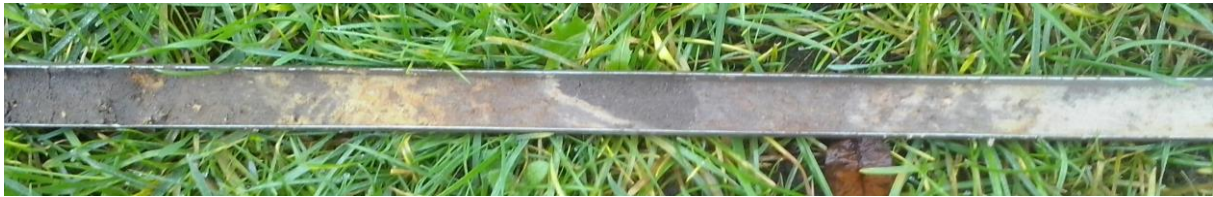
Figuur 17: Foto van boring 4 met de menglaag die tussen de humusrijke toplaag (links) en het ongeoxideerde zand van de C-horizont (rechts) ligt.
