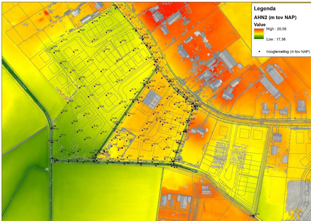
Figuur 2.1 Maaiveldhoogten uit AHN2 en hoogtemetingen (gemeente Geldrop-Mierlo, 2017)
