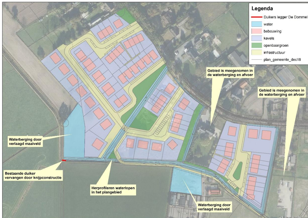
Figuur 5.1 Aanpassingen watersysteem ten behoeve van waterberging
