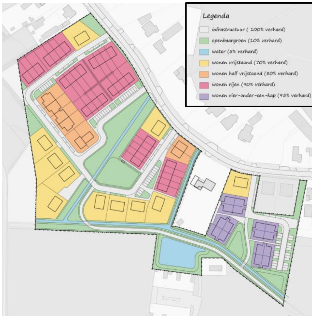
Figuur 4.9: stedenbouwkundig plan en bepaling maximaal verhard oppervlak
