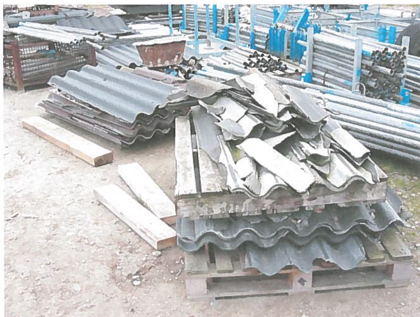
Foto 8: opslag asbestverdacht materiaal (golfplaten)
