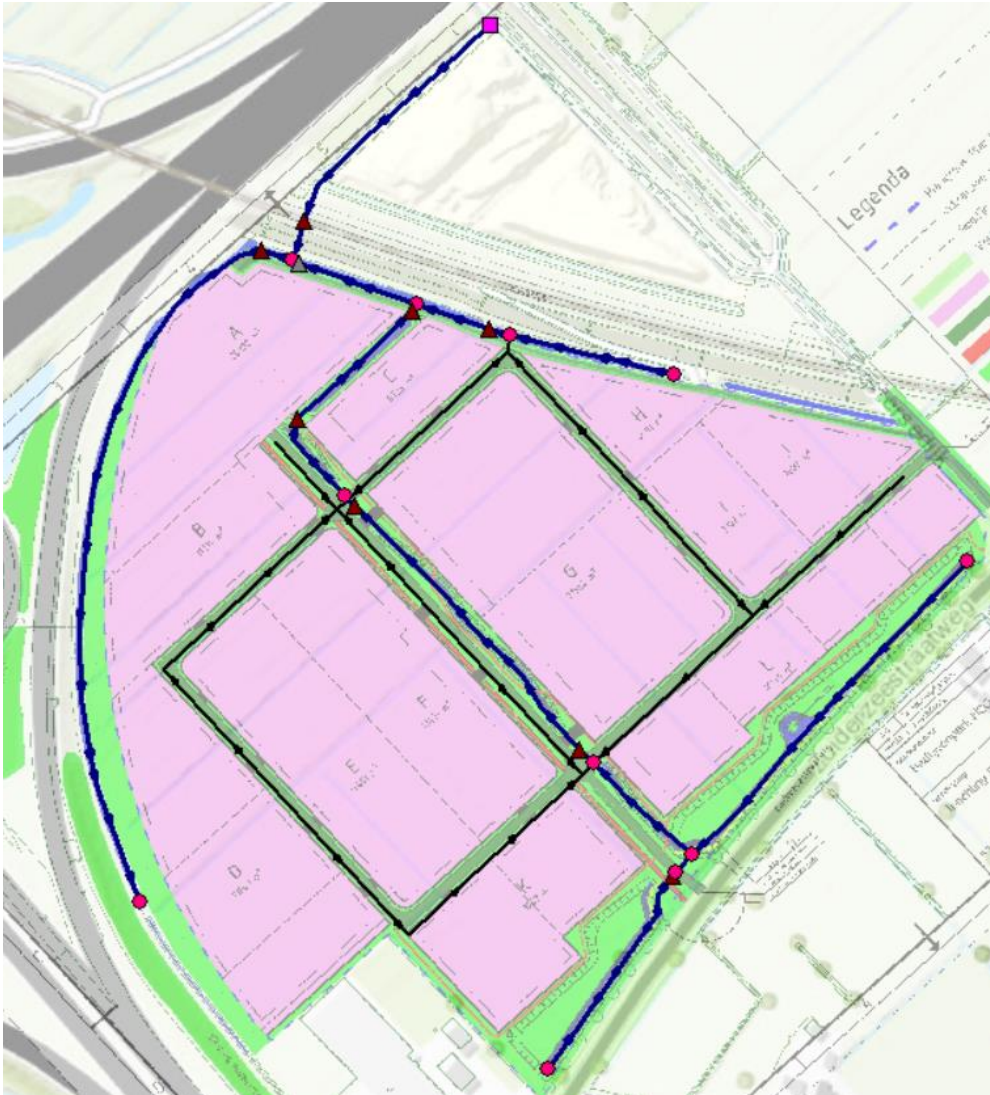
Figuur 15: Modelscope, met in zwart het HWA stelsel en in blauw het oppervlaktewater. De grijze driehoek geeft de stuw weer die het peil in het plangebied reguleert. De bruine driehoeken zijn de duikers in de watergangen.
