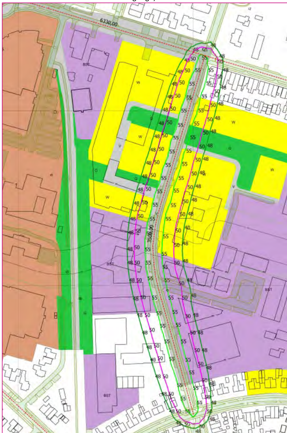
Figuur 5.5: overzicht van de berekende geluidbelasting L_{den} in dB vanwege de Populierenlaan (geluidcontouren inclusief 5 dB aftrek art. 110g Wgh)
