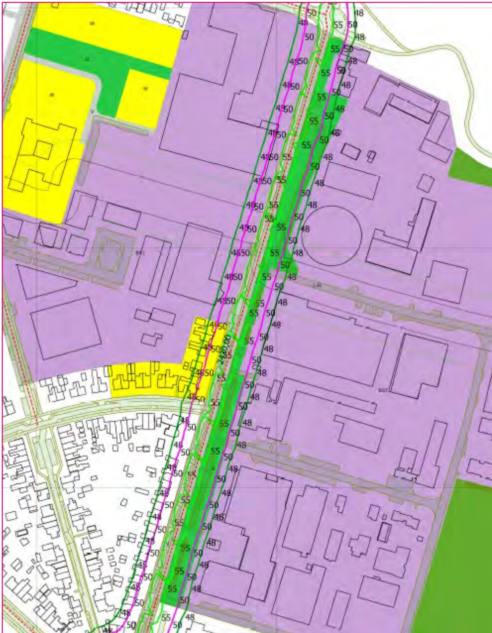
Figuur 5.3: overzicht van de berekende geluidbelasting L_{den} in dB vanwege de Burgemeester Moslaan (geluidcontouren inclusief 5 dB aftrek art. 110g Wgh)
