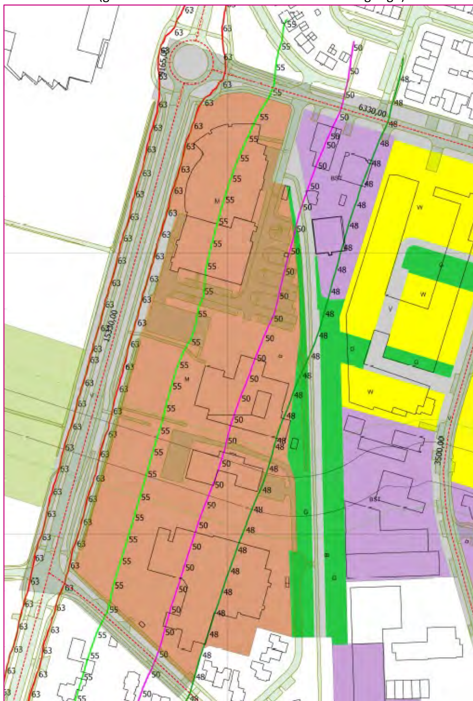
Figuur 5.1: overzicht van de berekende geluidbelasting L_{den} in dB vanwege de Apeldoornseweg/Nieuweweg (geluidcontouren inclusief 5 dB aftrek art. 110g Wgh)
