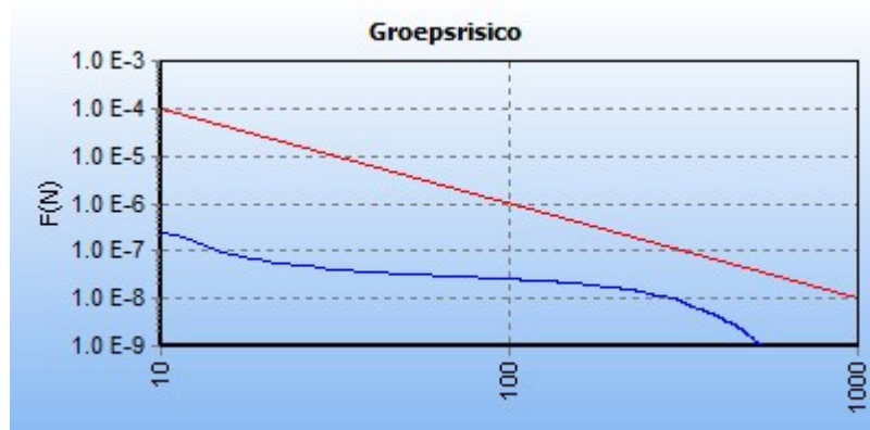
5.1 Figuur 5.1 FN curve voor 8328_leiding-N-556-60-deel-1 van N.V. Nederlandse Gasunie voor de kilometer tussen stationing 1760.00 en stationing 2760.00
