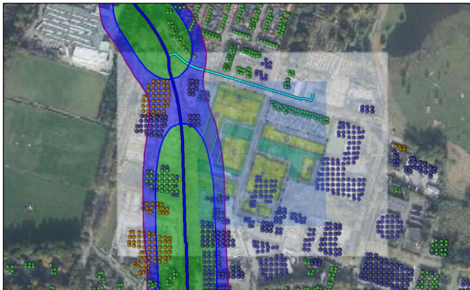
Figuur 6. risicocontouren leiding N-556-60, rode lijn PR 10^{-7} /jr, blauwe lijn PR 10^{-8} /jr
