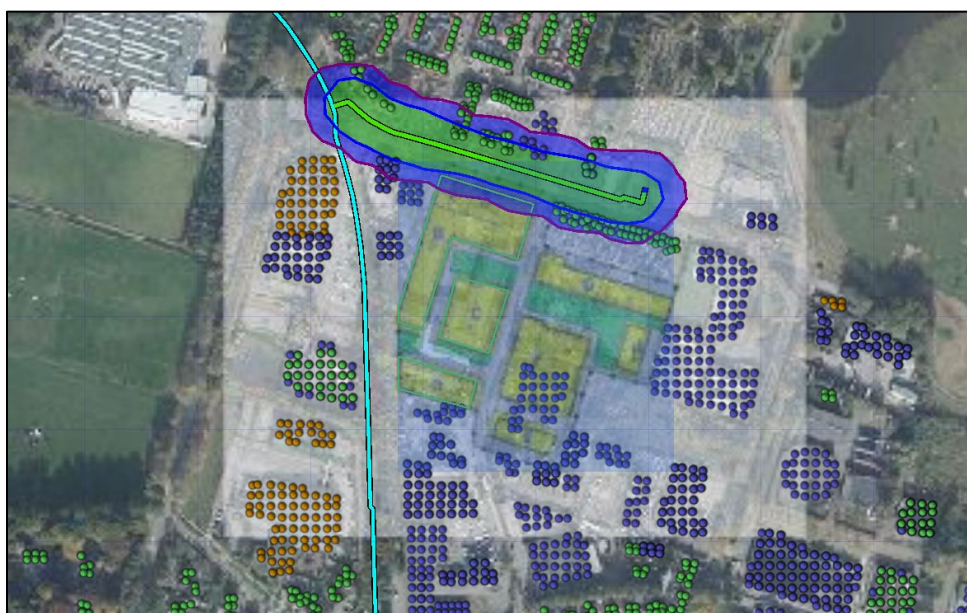
Figuur 7. risicocontouren leiding N-556-61, rode lijn PR 10^{-7} /jr, blauwe lijn PR 10^{-8} /jr
