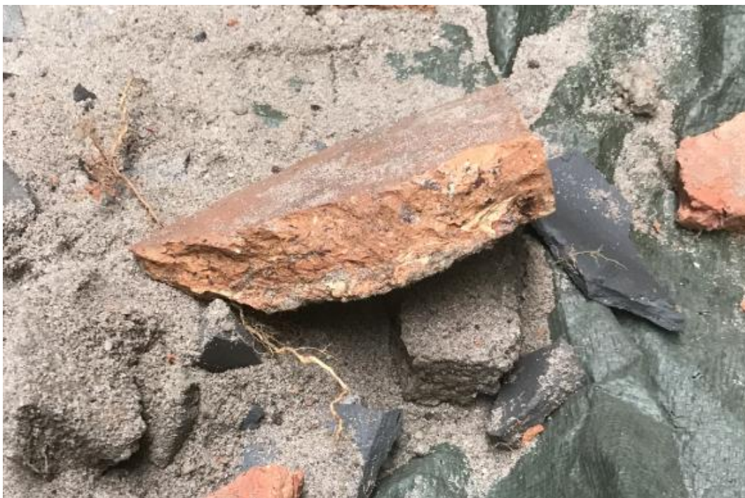
Afbeelding 3. Foto van puinverharding in boring 7.
