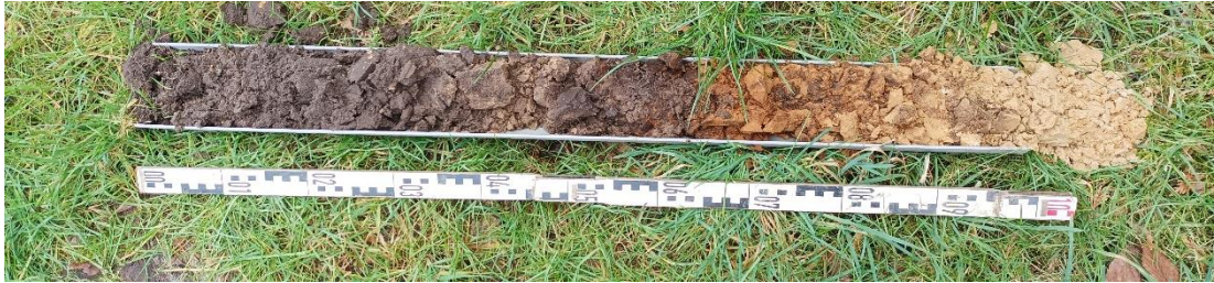
Afbeelding 13: Boorprofiel van boring 1 met v.l.n.r. de bruine bouwvoor, gevlekte menglaag met brokjes zwart veraard veen, de zwak ontwikkelde oranje podzol en het gele dekzand.
