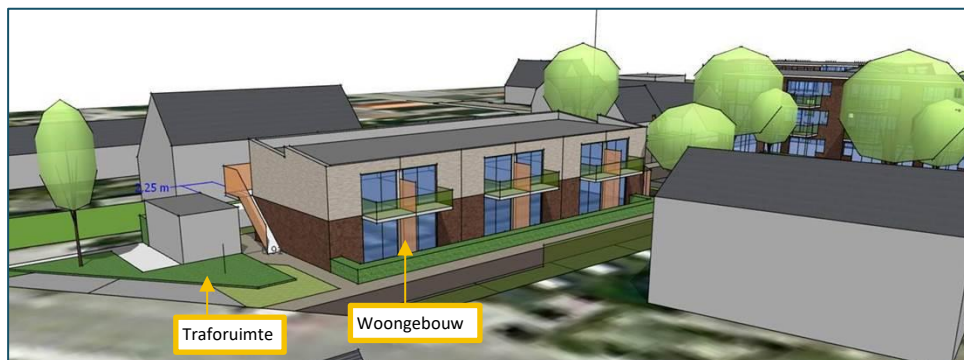
Figuur 1 Situering traforuimte en het nieuwe woongebouw
