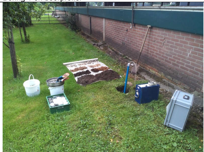
Opstelling boring 6 en peilbuis
