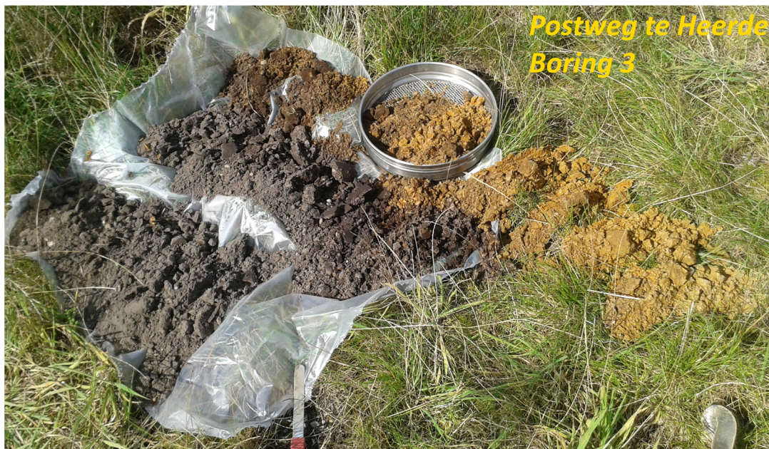
Afbeelding 2.2: Foto van boring 3. Linksonder van links naar rechts uitgelegd de toplagen (donkere eerdgrond) verlopend naar uiteindelijk het gele zand (C-horizont).
