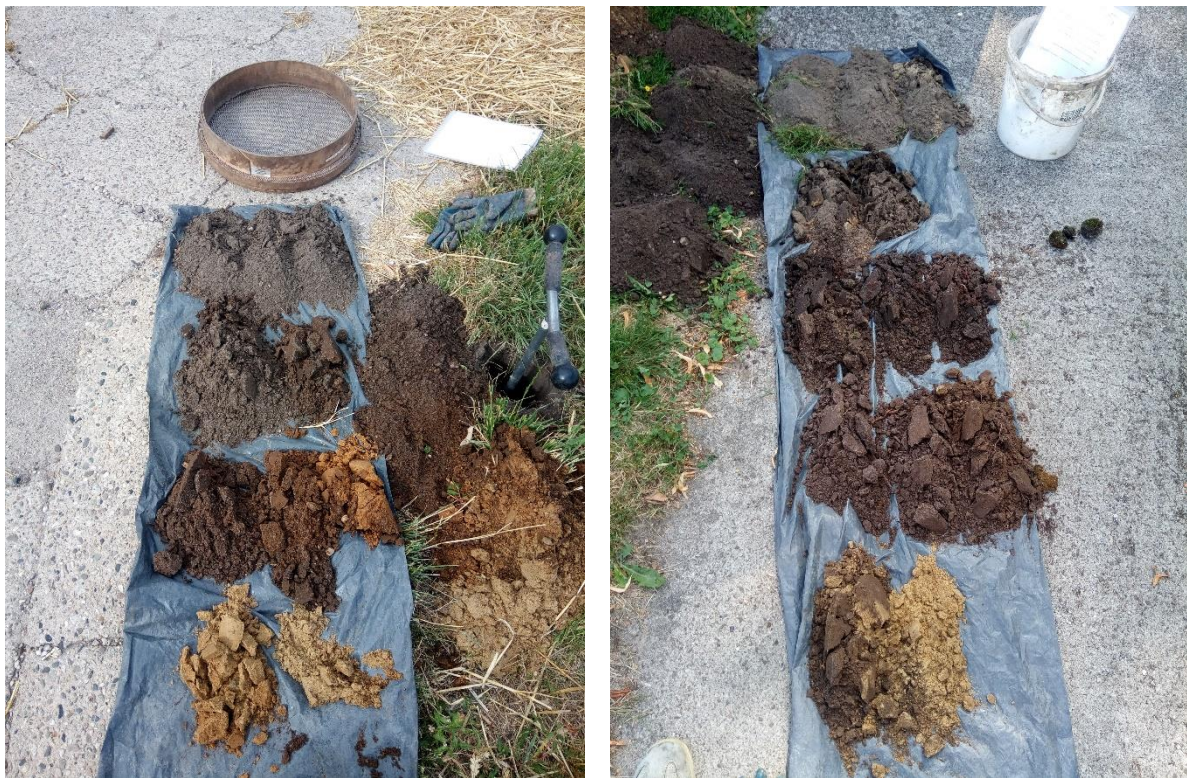
Figuur 15: De bodemopbouw in boring 1 (links) en boring 2 (rechts)
