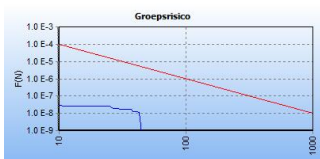
Figuur 13 FN-curve van de kilometer met de hoogste overschrijdingsfactor van gastransportleiding N-570-20 in de huidige situatie. De ligging van deze kilometer is hiernaast in het rood weergegeven op een topografische kaart.
