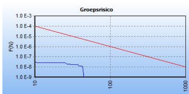
Figuur 15 FN-curve van de kilometer met de hoogste overschrijdingsfactor van gastransportleiding N-570-20 in de toekomstige situatie. De ligging van deze kilometer is hiernaast in het rood weergegeven op een topografische kaart.
