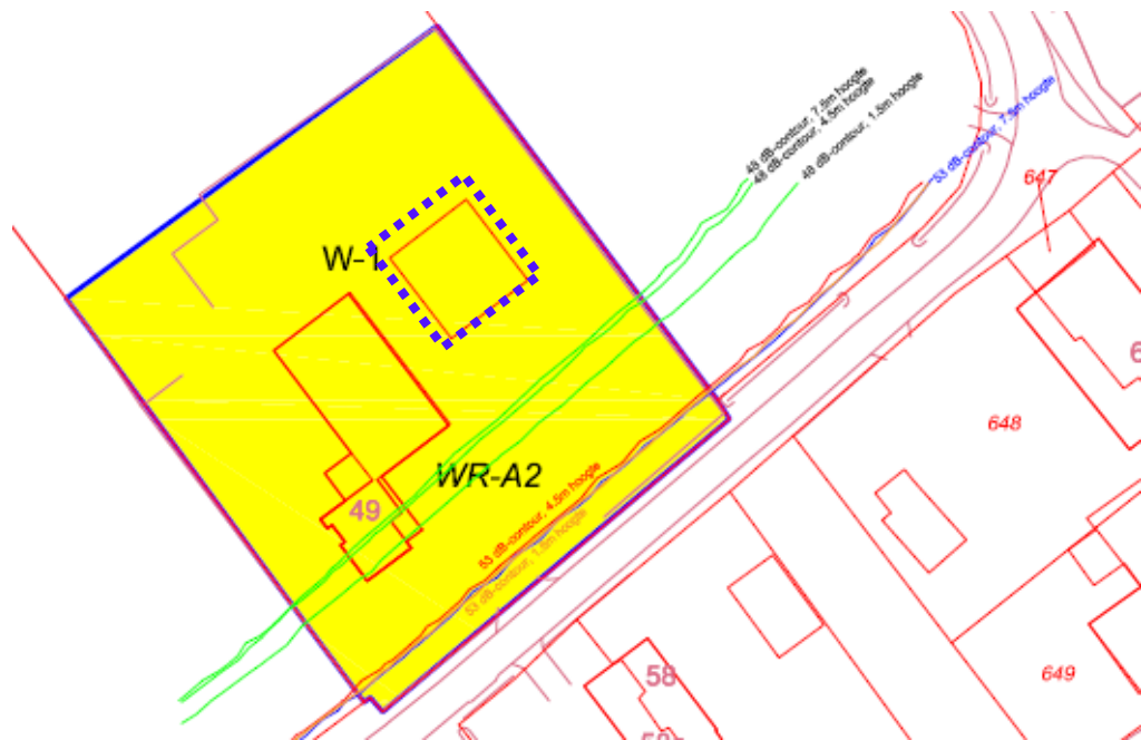
Resultaten akoestisch onderzoek: rood=53 dB-contour (maximale ontheffingswaarde), groen=48 dB-contour (voorkeursgrenswaarde) en blauw gestippeld=bouwwvlak nieuwe woning
