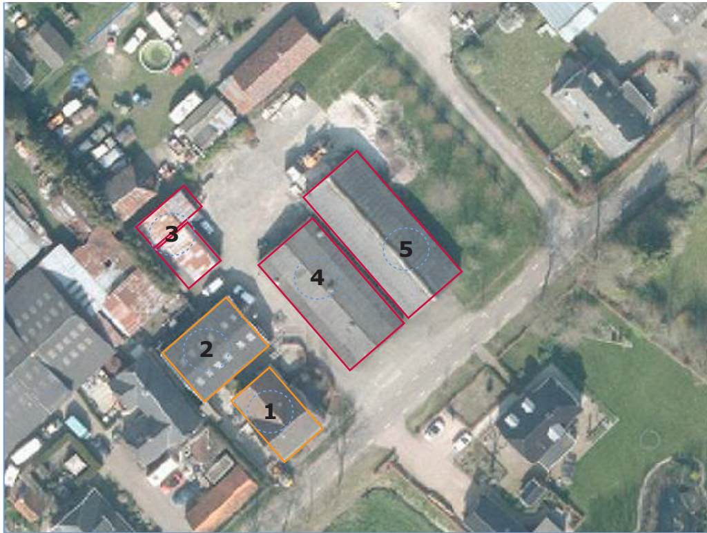
Bebouwing Duivendansweg 4 Rood: te slopen bebouwing. Oranje: te behouden woonhuis en bijgebouw
