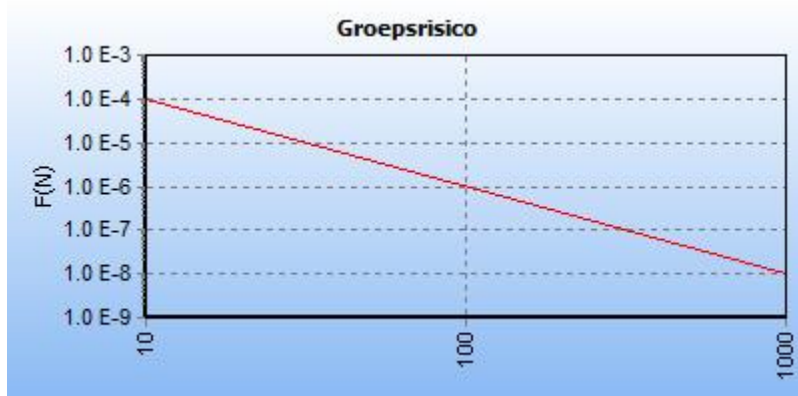
5.9 Figuur 5.9 FN curve voor 6096_leiding-N-570-37-deel-1 van N.V. Nederlandse Gasunie voor de kilometer tussen stationing 0.00 en stationing 480.00
