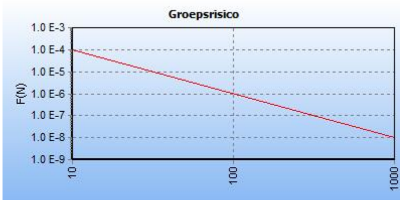
5.7 Figuur 5.7 FN curve voor 6096_leiding-N-570-29-deel-1 van N.V. Nederlandse Gasunie voor de kilometer tussen stationing 0.00 en stationing 360.00
