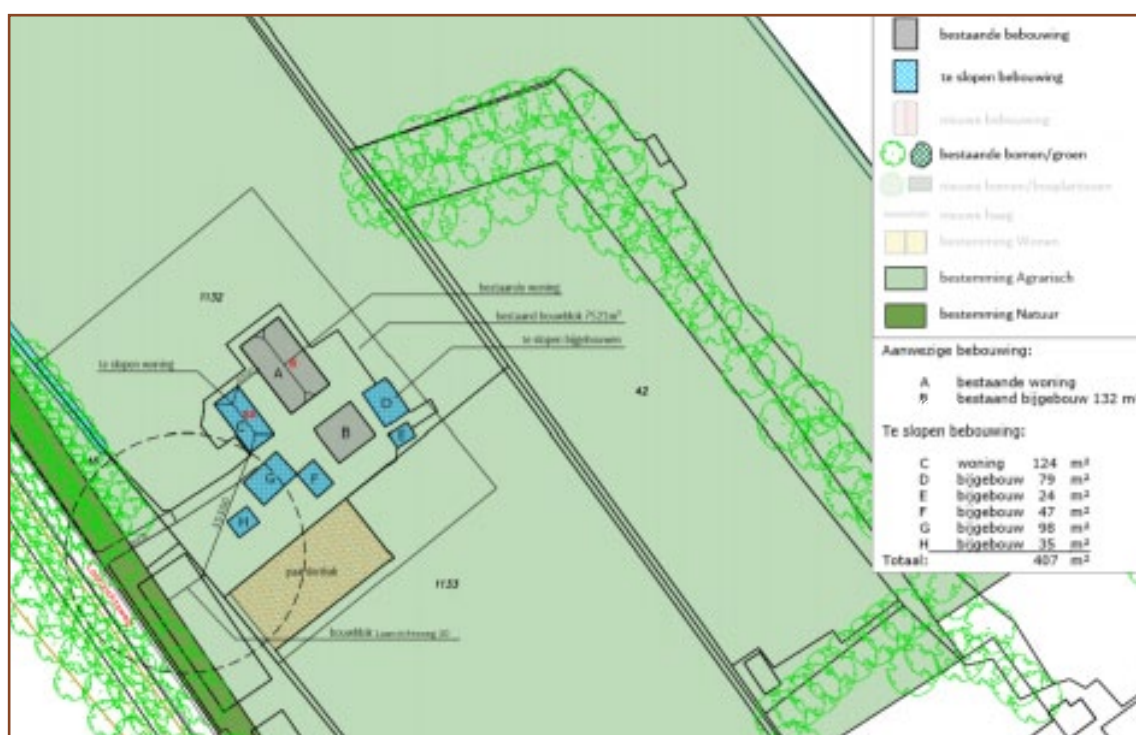
Afbeelding 2: Plangebied met de huidige situatie en de te slopen gebouwen. Bron: BNL Nunspeet, 14-02-2020.
