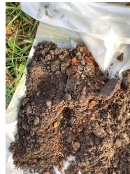
meetpunt 02, laag 0-50, bijz. metselpuin 387581297
