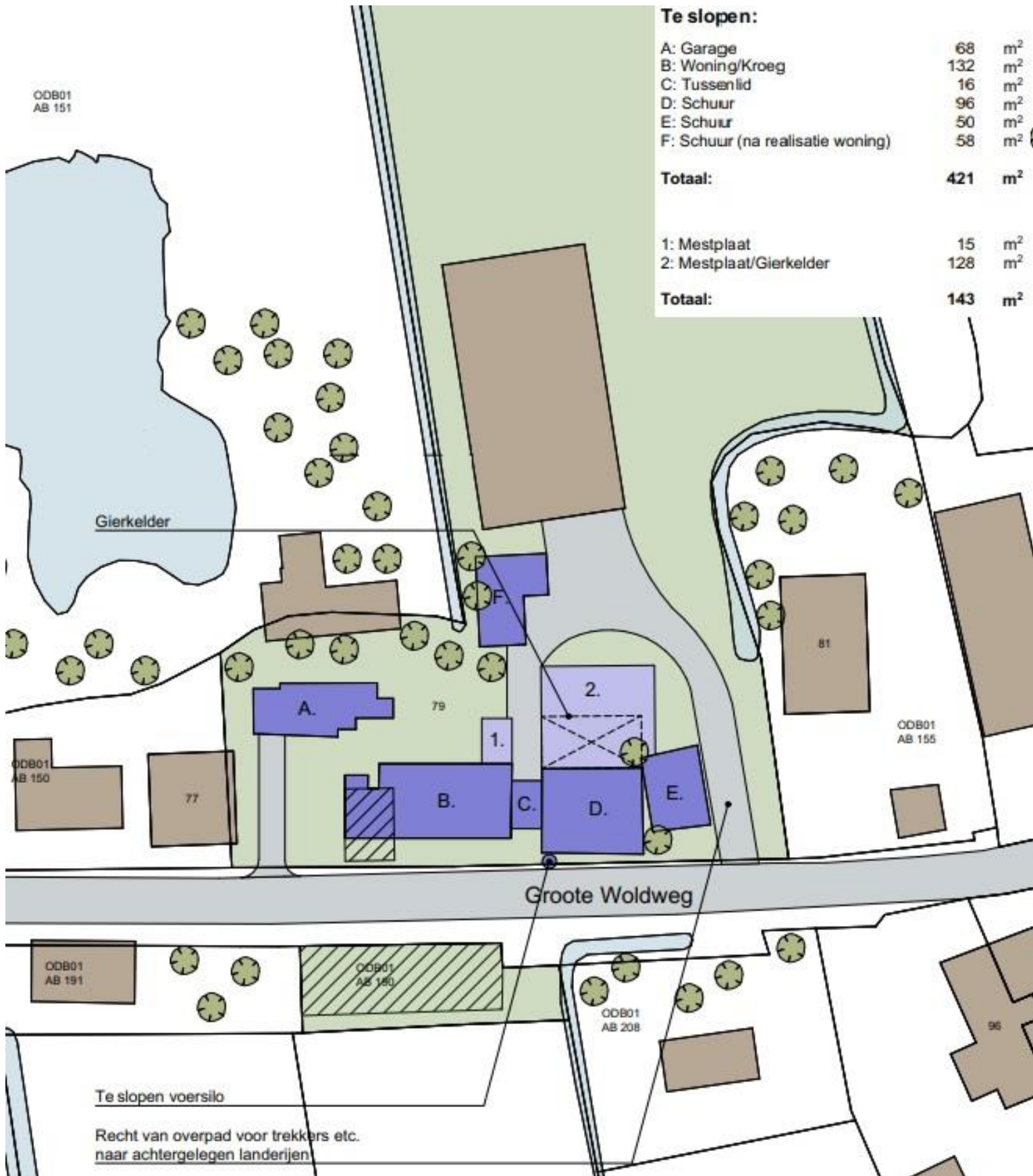
Overzicht te slopen bebouwing
