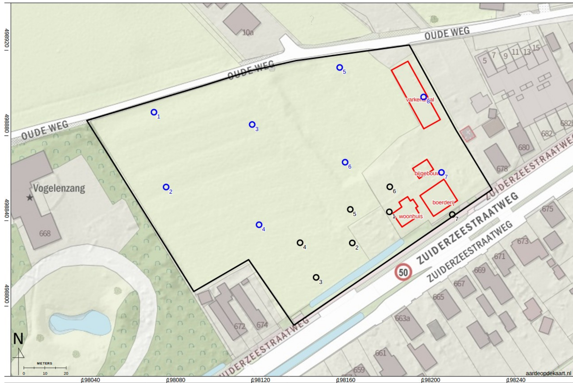
Figuur 20: Boorpuntenkaart (zwarte boorpunten zijn van MUG), geplaatste boorpunten in blauw. In rood de contouren van gesloopte bebouwing.
