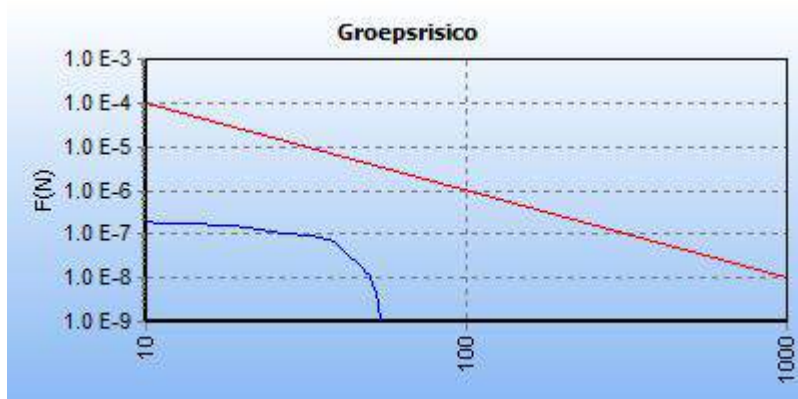
5.1 Figuur 5.1 FN curve voor 6265_leiding-N-570-20-deel-1 van N.V. Nederlandse Gasunie voor de kilometer tussen stationing 5020.00 en stationing 6020.00
