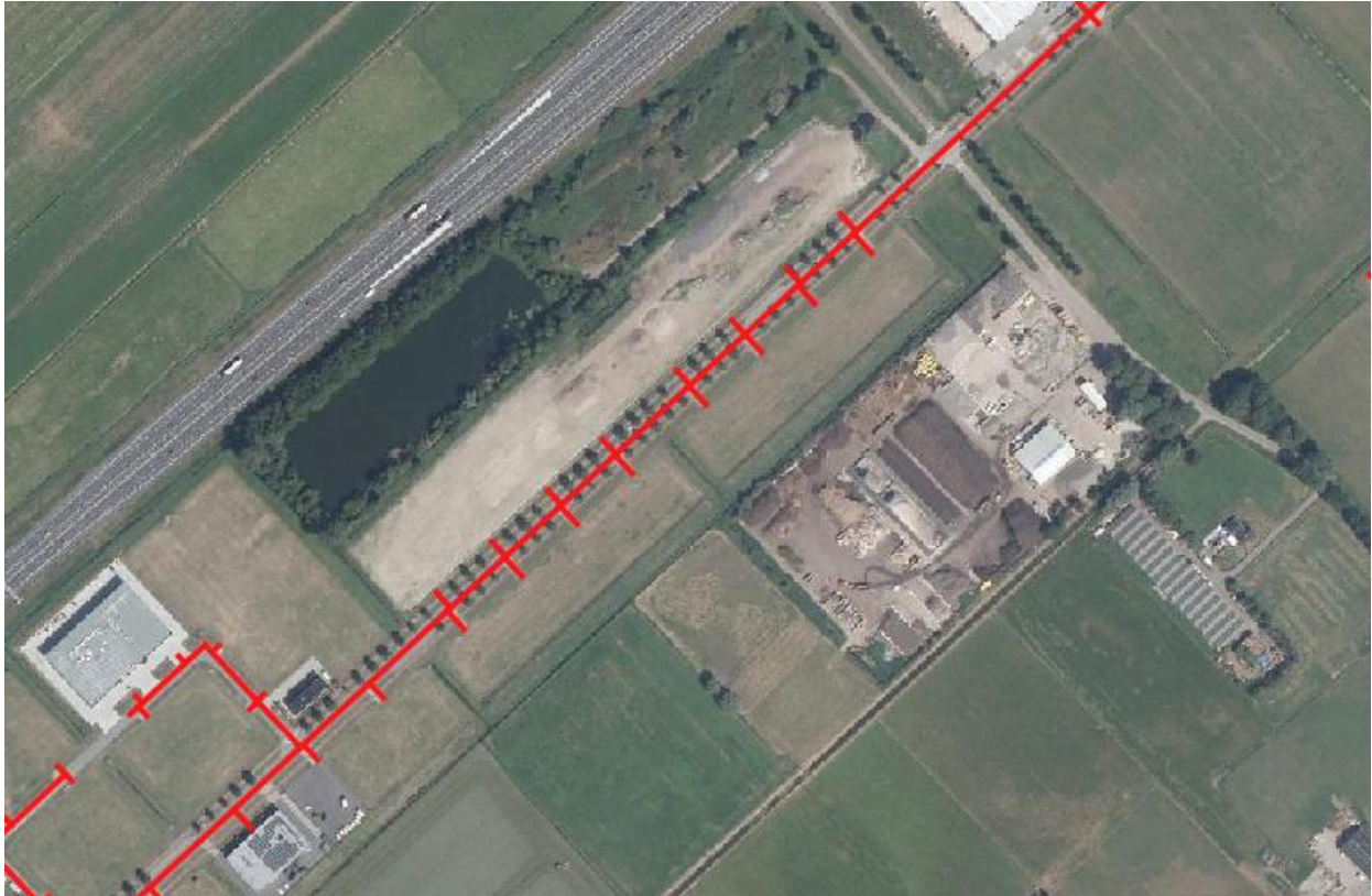
Figuur 2-4 DWA-riolering duurzaamheidsstraat, inclusief uitleggers.
