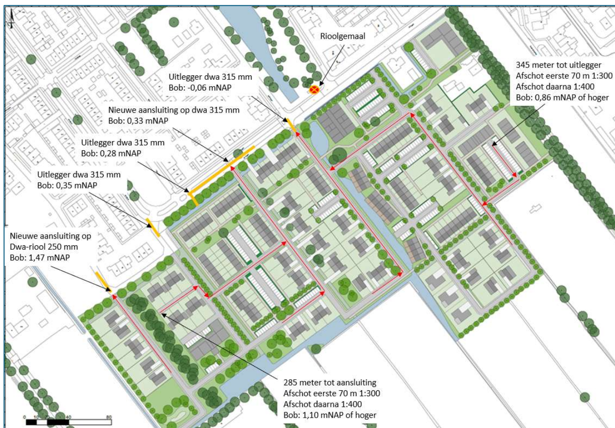
Figuur 15: Schetsontwerp hoofdstrengen vuilwaterstelsel Oldebroek West Fase III
