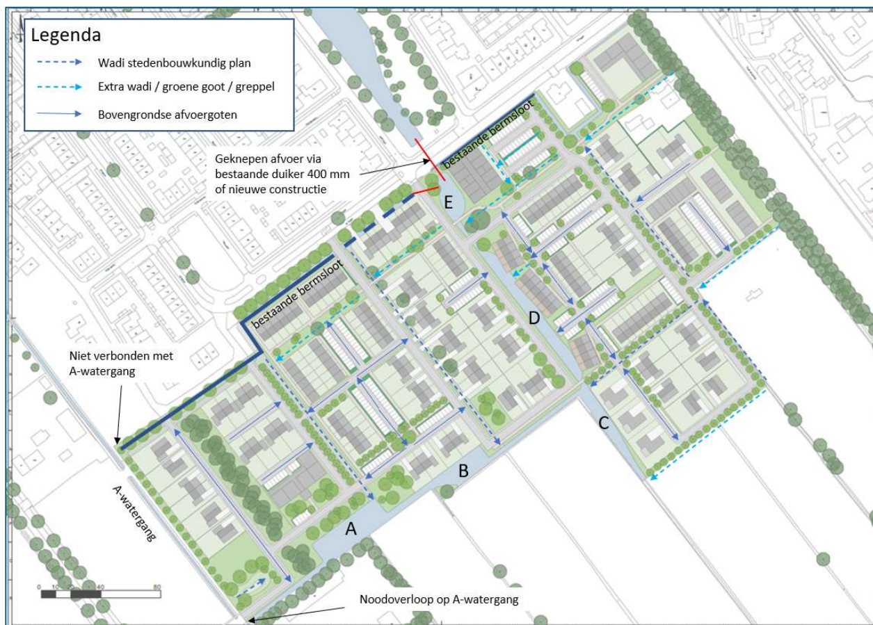
Figuur 13: Watersysteem Oldebroek West Fase III
