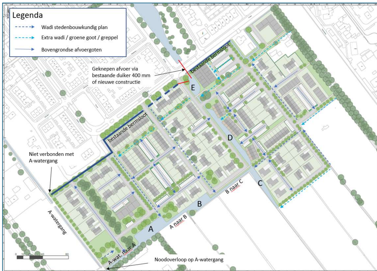
Figuur 14: Watersysteem Oldebroek West Fase III
