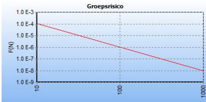
5.4 Figuur 5.4 FN curve voor N-570-20 van N.V. Nederlandse Gasunie voor de kilometer tussen stationing 16110.00 en stationing 17110.00
