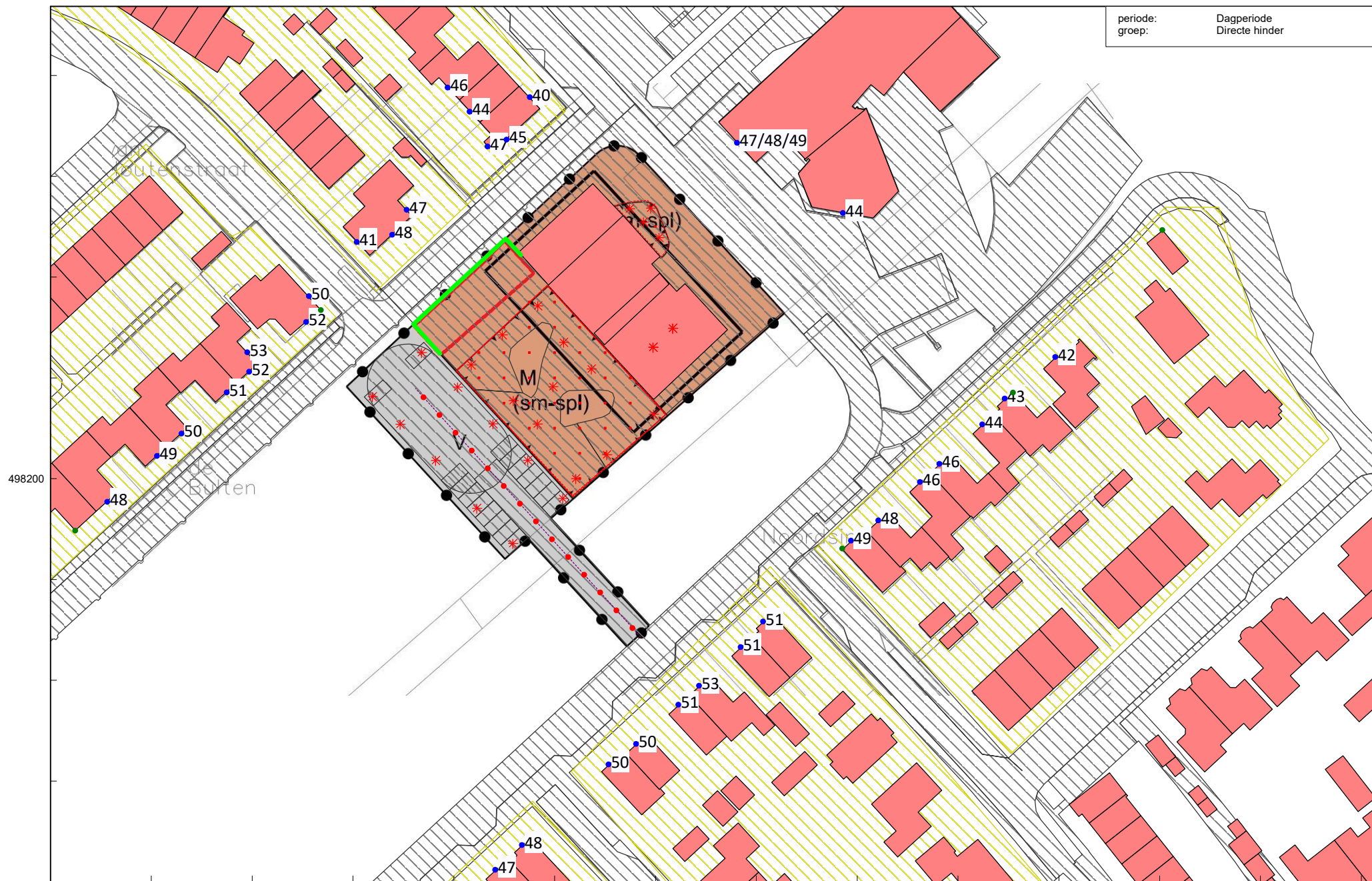
Figuur 1 Optredende langtijdgemiddelde beoordelingsniveaus in de dagperiode op begane grond woningen met een berging/fietsenstalling met een hoogte van 2,5 meter aan de noordwestzijde van het terrein Achter- en zijwanden volledig gesloten, naad- en kierdicht
