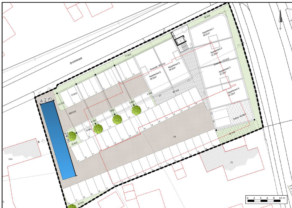
Figuur 7.1 Situering infiltratiekratten
