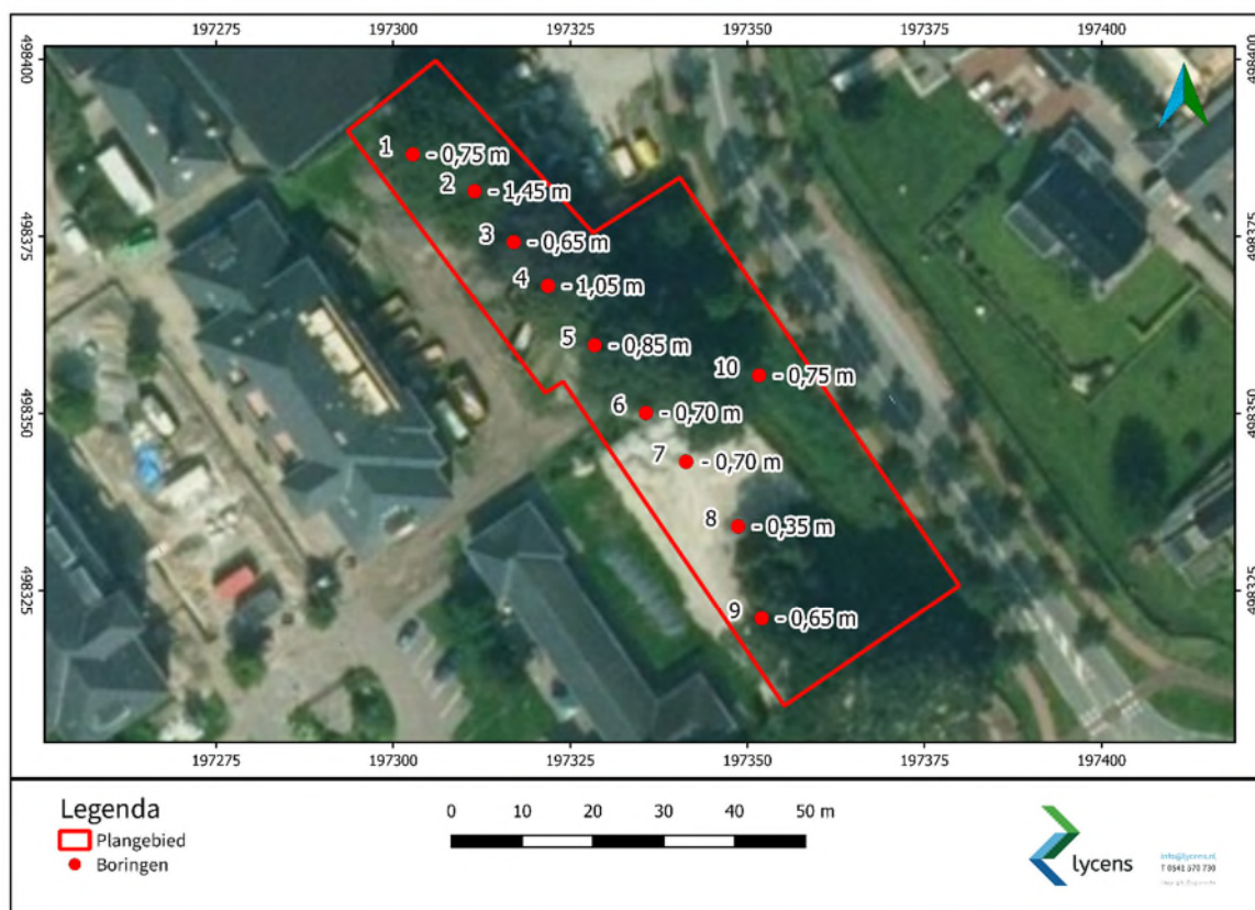
Afbeelding 7 Resultaten van het booronderzoek. Diepte verstering in meters beneden maaiveld.
