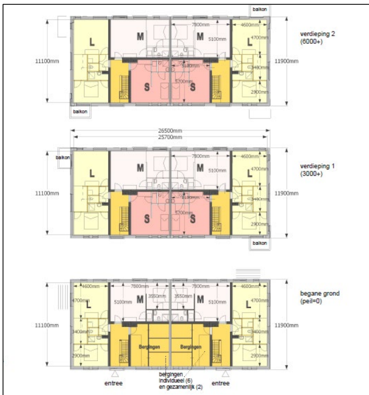
Afbeelding 3.1 Plattegronden (Bron: BDC architecten)
