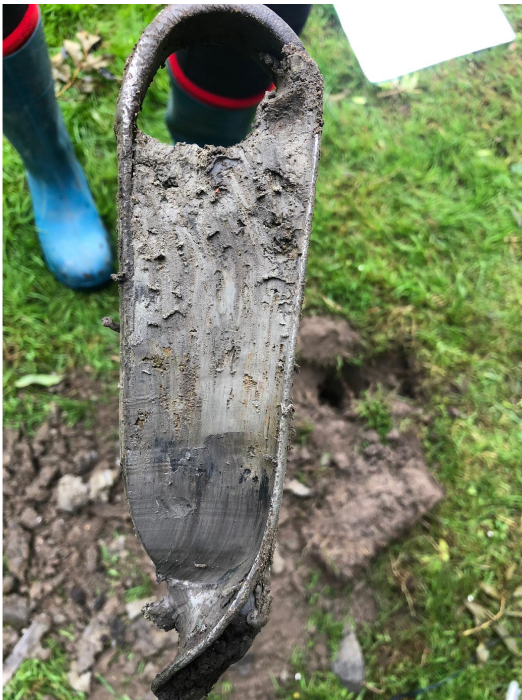
Afbeelding 4: Een doorsnede van boring 1 verricht met een Edelmanboor op 1-1,3 meter diepte. Zichtbaar is het bruingrijze rijpe kleipakket waarin humeuze vlekken zichtbaar zijn.
