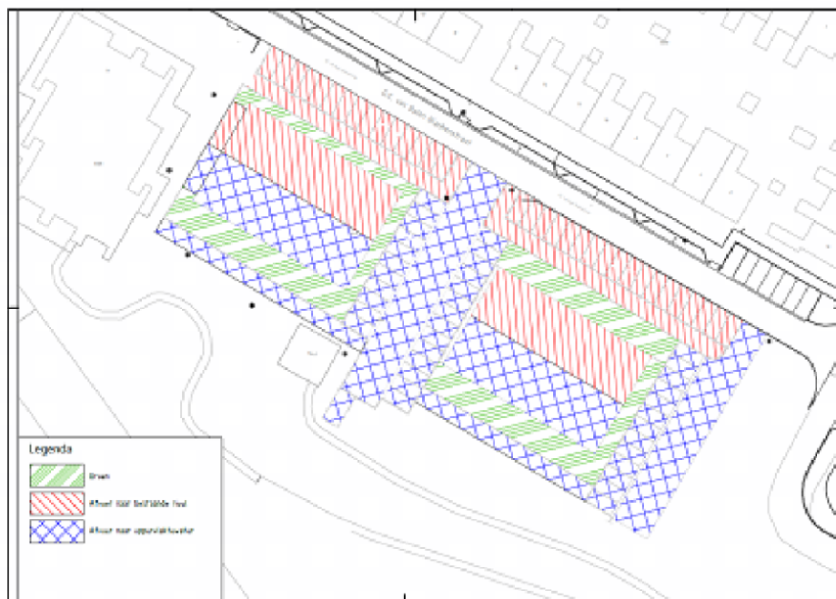
Figuur 6 Afstroming hemel- en afvalwater
