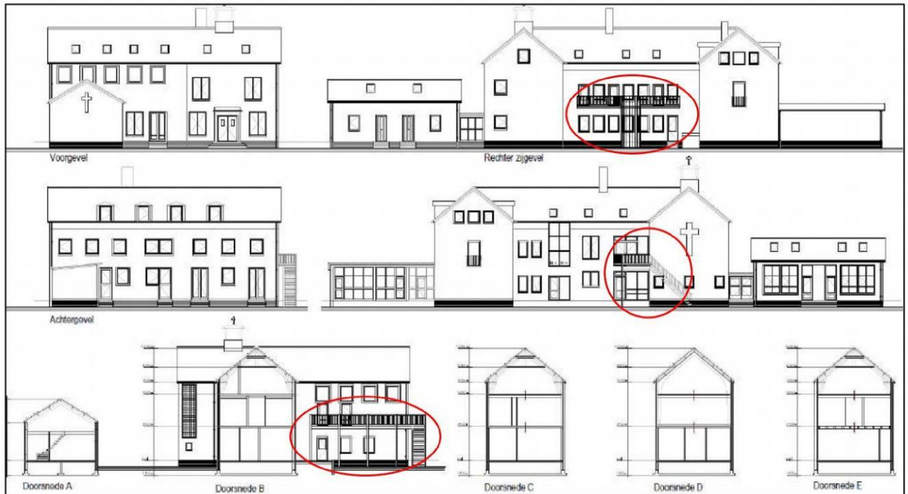
Afb 3: Gevelaanzichten. In de rode ovaal de wijzigingen
