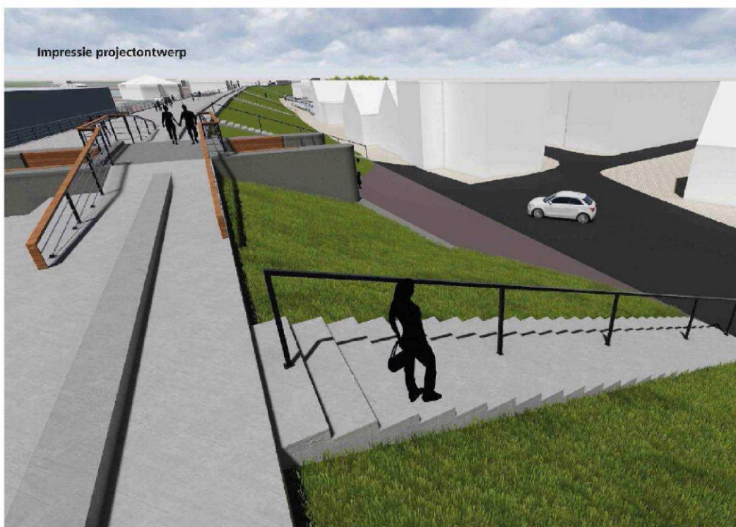
Figuur 7: Impressie binnentalud met gras en dijktrappen
