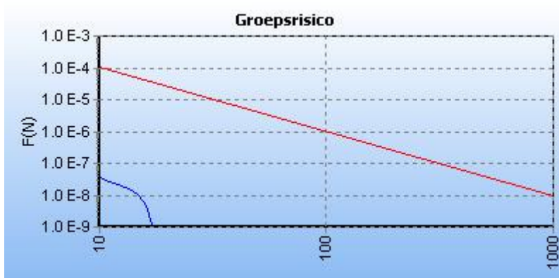
Figuur 20: FN curve behorend bij de boven aangegeven kilometer leiding.
