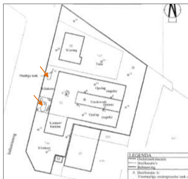
Ligging (voormalige) ondergrondse brandstoftanks met pomp volgens rapport SMA Zeeland B.V., 22 juli 2005
