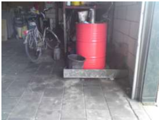
Olievat in lekbak voorin de loods, naast de deur
