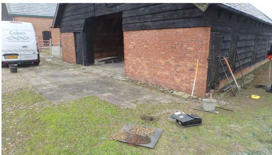
foto 2: situering van boring 207 waar een sterke verontreiniging is aangetroffen (4,5 keer de interventiewaarde), oorzaak is mogelijks uitspoeling door regen v.h. houtwerk behandeld met teer. (westelijke richting)
