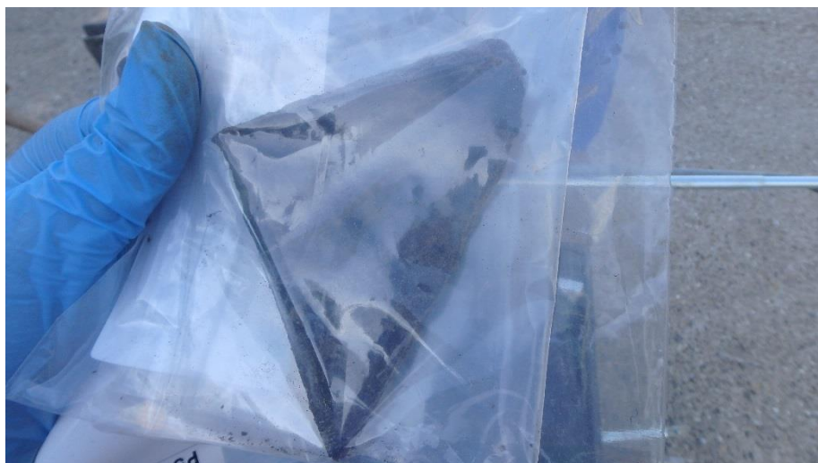
foto 7: Asbest verdacht materiaal (M.asb.1) (- richting)
