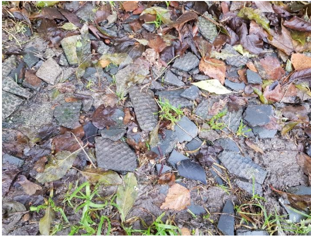
Foto 70 | Foto voor bron Golfplaat (verontreiniging)
