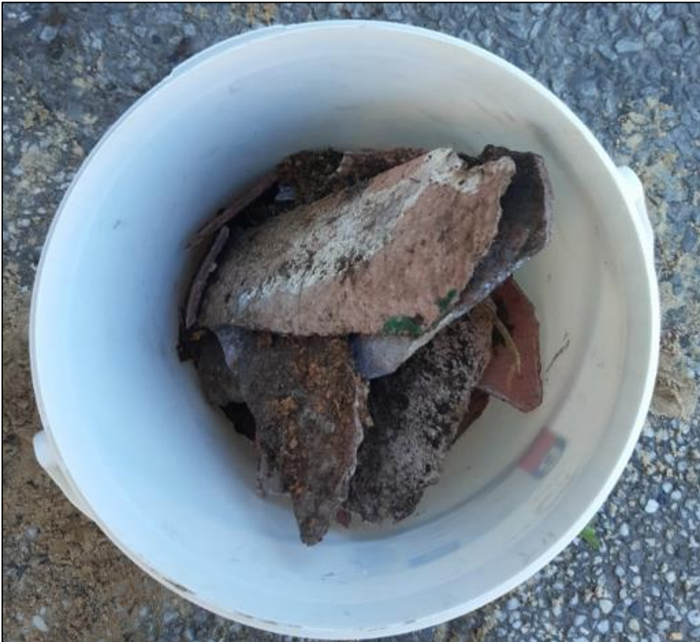
Foto 6: Middels handpicking verzameld asbestverdacht plaatmateriaal afkomstig van de betonplaat
