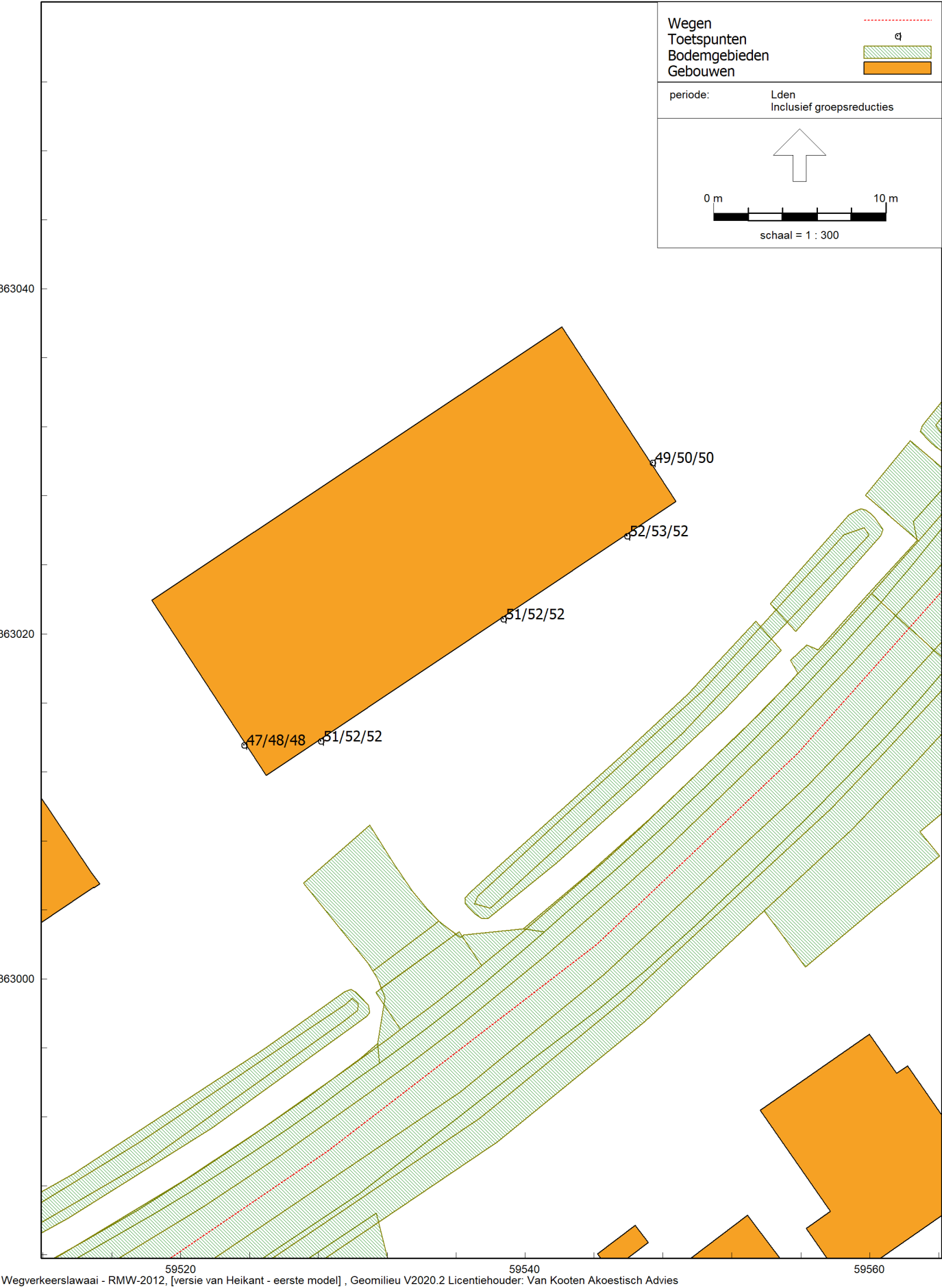
Geluidsbelasting vanwege de Julianastraat op de begane grond/1e/2e verdieping Waarden in Lden na toepassing van de aftrek van 5 dB conform artikel 110g van de Wet geluidhinder
