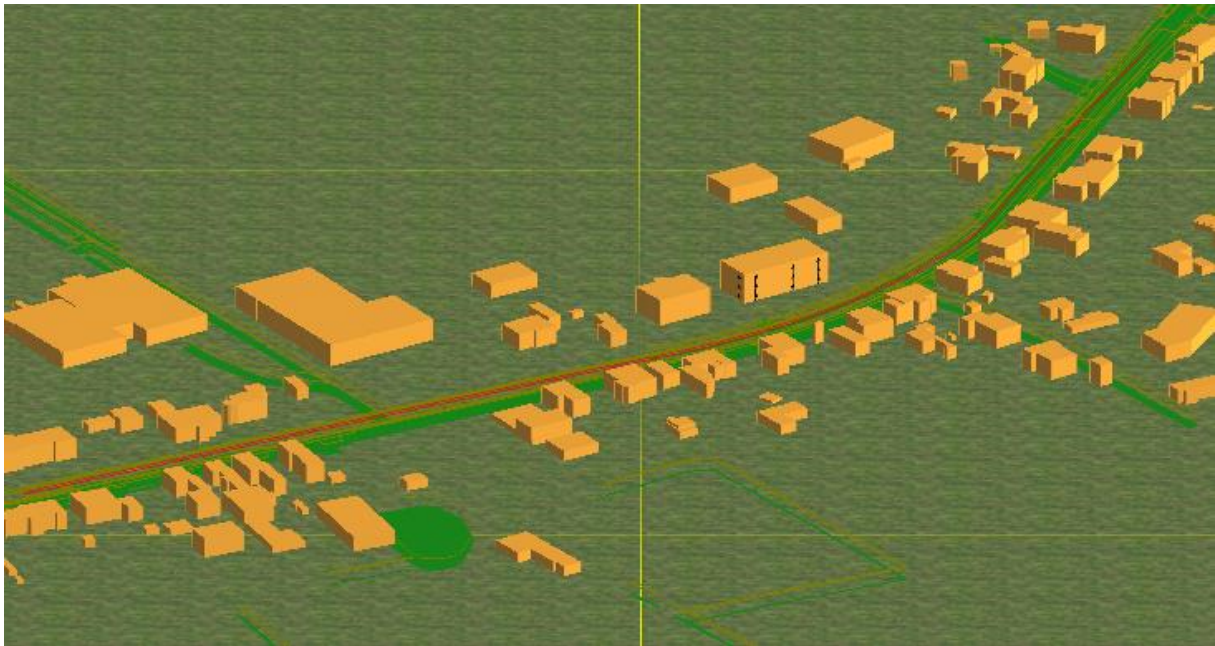
Afbeelding: 3D impressie van het rekenmodel voor wegverkeerslawaaai (vanuit een gezichtspunt ten zuiden van de planlocatie)
