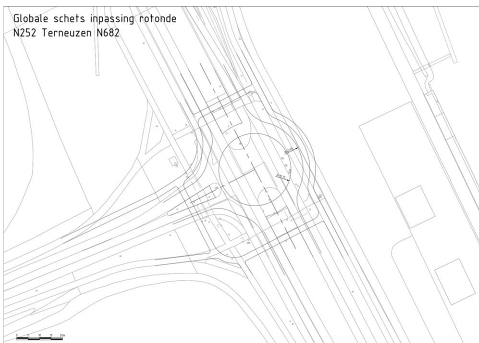
Afbeelding 3.20: globaal ruimtebeslag enkelstrooksrotonde (afwijkende diameter van 42 meter)
