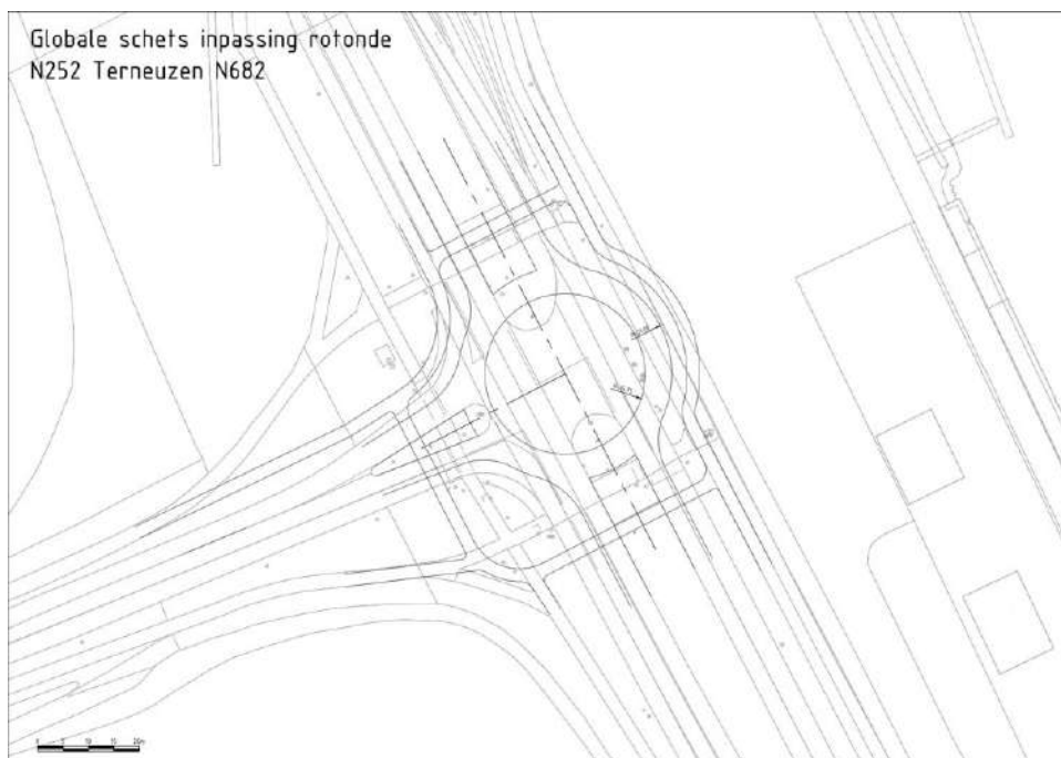
Afbeelding 3.20: globaal ruimtebeslag enkelstrooksrotonde (afwijkende diameter van 42 meter)
