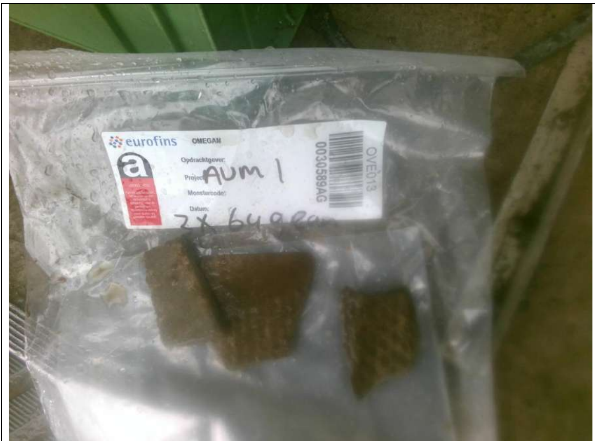
Foto 7: Asbestverdacht materiaal uit proefgat 301
